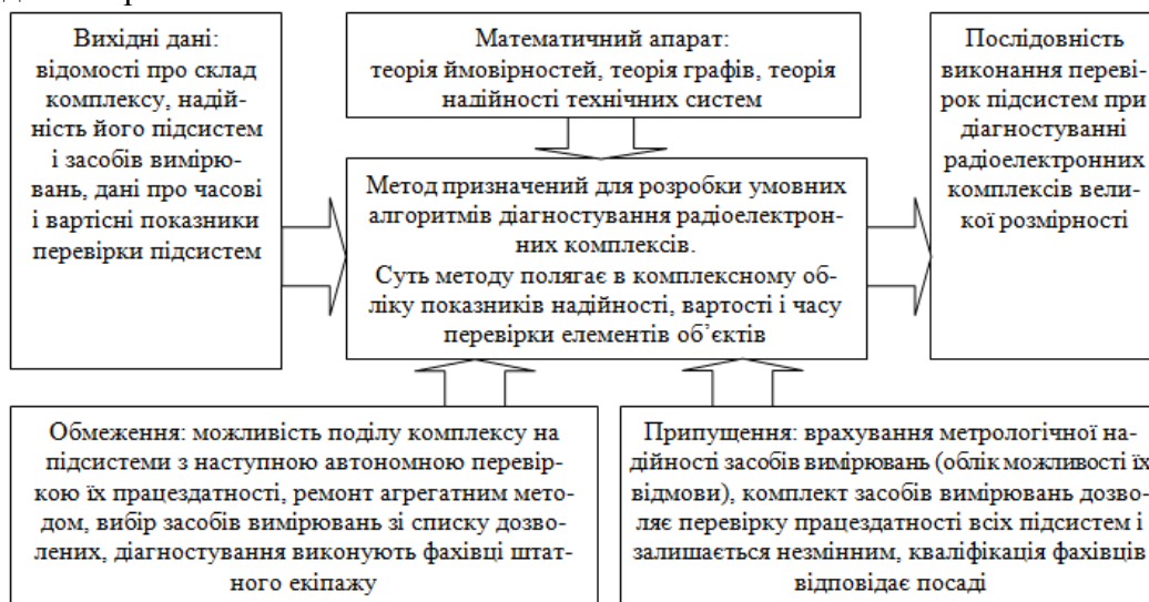
Рисунок 1 – Схема реалізації методу розробки алгоритмів діагностування радіоелектронних комплексів
