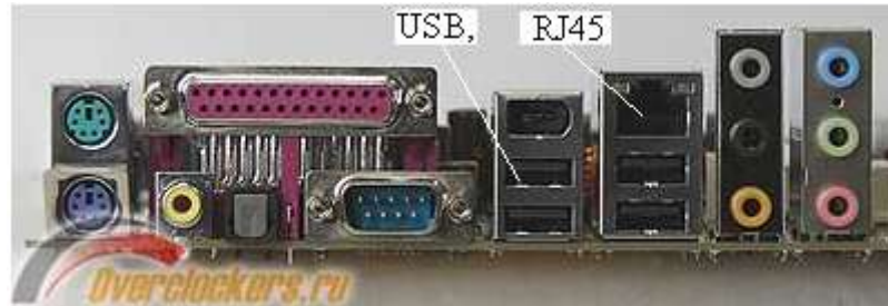
Рис. 2.11- Розташування рознімання USB та RJ-45 на материнській платі
