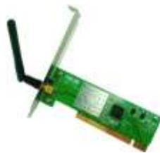
б) Мережна карта стандарту 802.11g, виробник Asus, PCI
