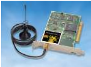
а) Мережна карта стандарту Radio Ethernet, виробник LG Electronics, PCI
