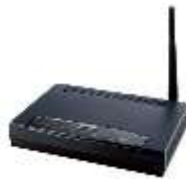
б) зовнішній Модем Zyxel P-660HW (ADSL) Швидкість обміну: 256К.
